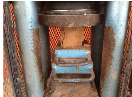
รูปที่ 5 การทดสอบความต้านแรงอัด
