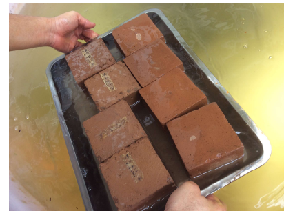
รูปที่ 6 การทดสอบการดูดซึมนํ้า
