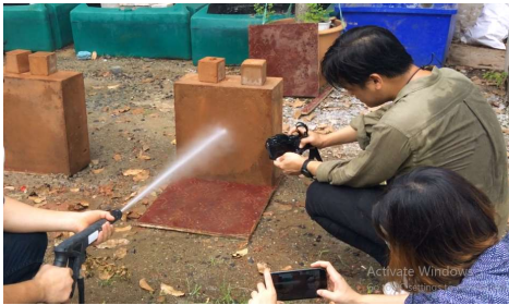
รูปที่ 8 การทดสอบการฉีดผนังดินด้วยน้ำด้วยน้ำแรงดันสูง 120 บาร์
