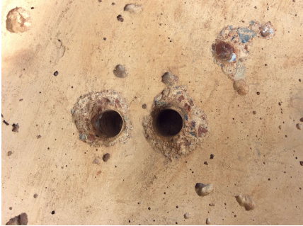
รูปที่ 14 ผลการเจาะรูบล็อกผนังดินซีเมนต์ด้วยสว่านไฟฟ้า
