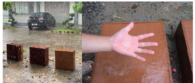
รูปที่ 12 การใช้ฝ่ามือลูบที่ผิวหน้าของบล็อกผนังดินซีเมนต์หลังจากปล่อยให้ตากผน 1 วัน
