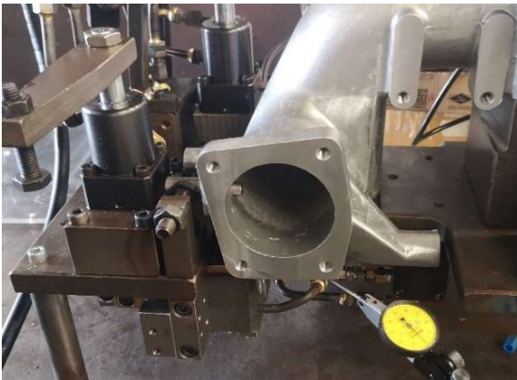
ภาพที่ 14 การวางชิ้นงานท่อไอดีเข้ากับอุปกรณ์นำเจาะและจับงานเพื่อทดสอบ
