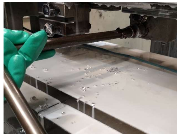
ภาพที่ 6 การขันสกรูล็อคเข้าและออกสำหรับตัวหมุนขึ้นงานแบบความยาวแปรผันแบบเดิม
