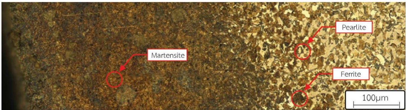
รูปที่ 14 โครงสร้างจุลภาคการอบเพิ่มคาร์บอนที่อุณหภูมิ 950 องศาเซลเซียส เวลา 4 ชั่วโมง
