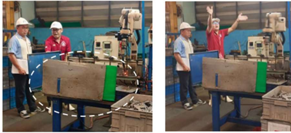
รูปที่ 6 แผงกันสะเก็ดไฟอุปสรรคในการทำงานของพนักงาน
