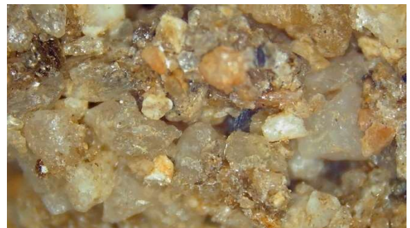
รูปที่ 7 ภาพตัดขวางของก้อนตัวอย่างที่มีปริมาณโพลีเมอร์ร้อยละ 17
