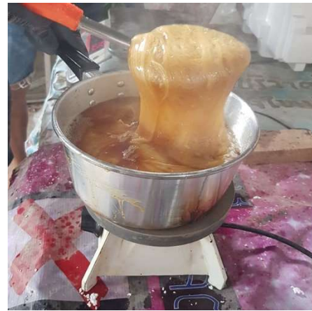
รูปที่ 3 หลอมละลายโฟม EPS ด้วยความร้อน
