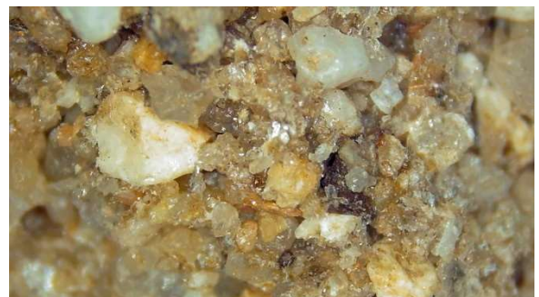
รูปที่ 8 ภาพตัดขวางของก้อนตัวอย่างที่มีปริมาณโพลีเมอร์ร้อยละ 20
