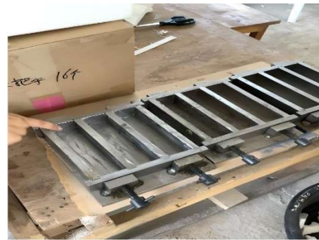
รูปที่ 4 แบบหล่อมาตรฐานขนาด 4x4x16 ซม.
