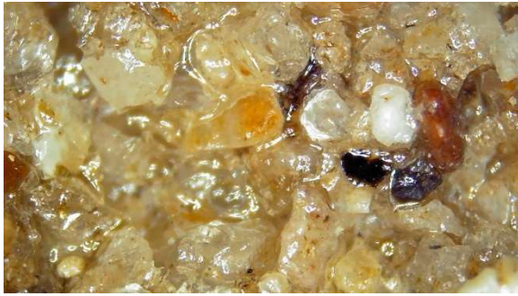
รูปที่ 9 ภาพตัดขวางของก้อนตัวอย่างที่ปริมาณโพรยละเอียด 50
