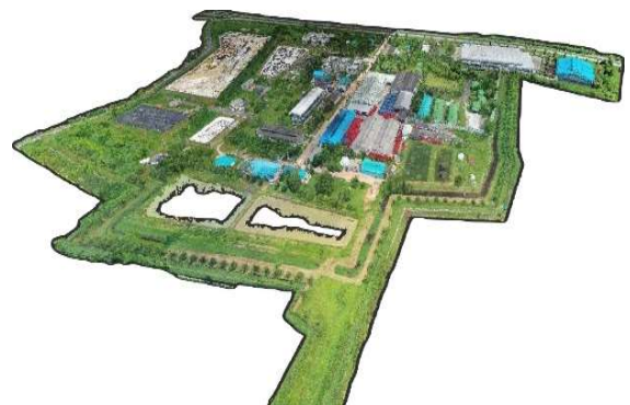
รูปที่ 1 แสดง Point Cloud ที่มีพิกัดสามมิติ X, Y, Z ค่าสี R, G, B
