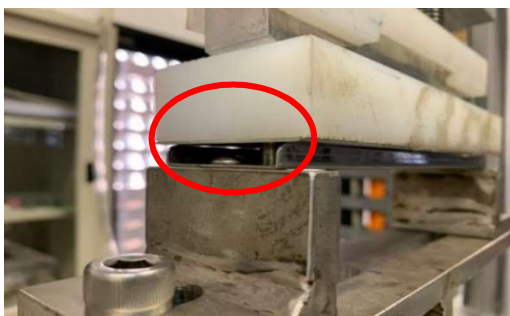
รูปที่ 34 ช่องว่างระหว่างถาดและแผ่นรองแม่แบบ
