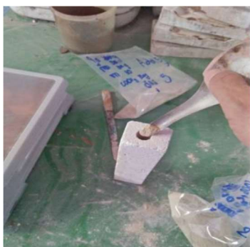
รูปที่ 2 การอัดผงเคลือบใส่ในแบบทนไฟ
