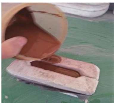
รูปที่ 3 การเทน้ำดินอ่างทองลงในแม่พิมพ์
