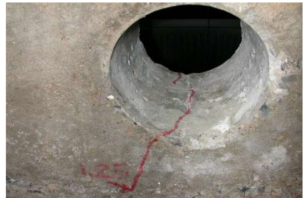
รูปที่ 13 รอยแตกร้าวจากแรงเฉือนเป็นลักษณะการวิบัติแบบคานสำหรับคาน BC-OCT และ BC-ODT
