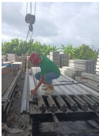
(ก) แสดงรูปการสวมตะขอเพื่อยกเสาไอแบบเดิม
