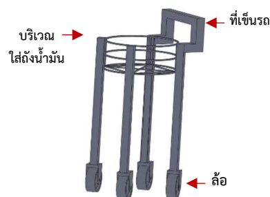
(ข) แสดงรูป Drawing อุปกรณ์ใส่ถังน้ำมันและเก็บอุปกรณ์ที่สามารถเคลื่อนที่ได้
