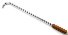
(ข) แสดงรูปตัวอย่างใช้ตะขอเกี่ยวดึงเหล็กออกเพื่อลดการก้ม
