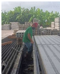
รูปที่ 12 ท่าทางที่ 12 เกลี่ยปูนคอนกรีตลงในแม่แบบ
