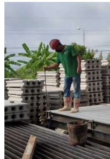
(ก) แสดงรูปท่าทางนำฝากันหัว-ท้ายออกแบบเดิม (ปรับปรุงโดยปรับขนาดชะแลงให้ใหญ่ขึ้น)
