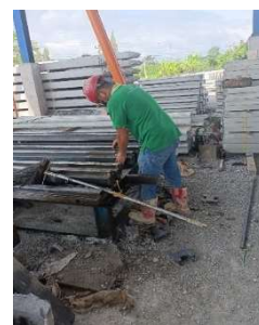
รูปที่ 2 ท่าทางที่ 2 ยกแม่แบบให้ตรงเพื่อใส่ไม้ดัด
