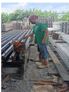
รูปที่ 5 ท่าทางที่ 5 ทาน้ำมันแม่แบบ
