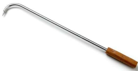
(ข) แสดงรูปตัวอย่างตะขอเกี่ยวเพื่อดึงเหล็กออกเพื่อลดการก้ม
