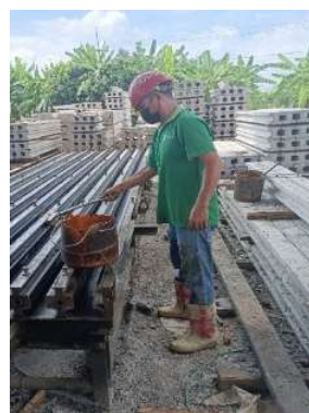
(ก) แสดงรูปการทาน้ำมันแม่แบบแบบเดิม
