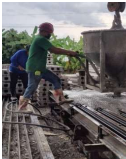
รูปที่ 11 ท่าทางที่ 11 เทปูนคอนกรีตลงในแม่แบบ
