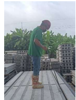
(ข) แสดงรูปท่าทางจัดเสาออกจากแม่แบบเดิม (ปรับปรุงโดยปรับขนาดชะแลงให้ใหญ่ขึ้น)
