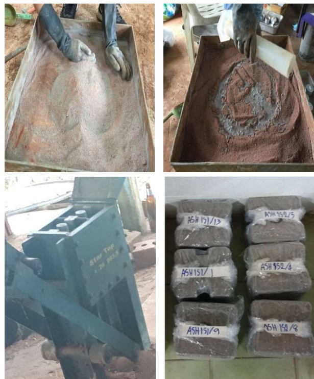
รูปที่ 5 การผสมวัสดุและการอัดบล็อกประสาน
