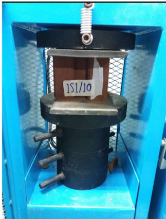
รูปที่ 6 การทดสอบกำลังอัดของก้อนตัวอย่างที่อายุ 7, 14 และ 28 วัน
