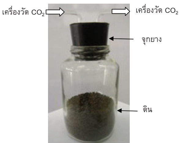
รูปที่ 1 ชุดทดสอบการย่อยสลายบรรจุภัณฑ์
