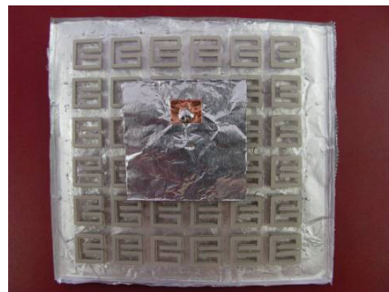
รูปที่ 8 การลดขนาดสายอากาศด้วยอภิวัด [3]
