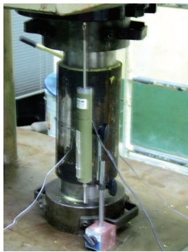
รูปที่ 3 การติดตั้งอุปกรณ์วัดระยะหดตัว (LVDT) กับตัวอย่างทดสอบ
