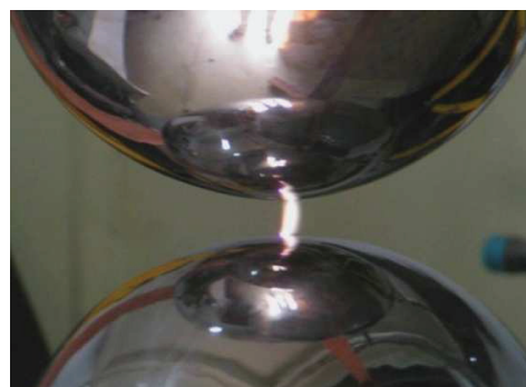
รูปที่ 8 ภาพถ่ายการเกิดเบรกดาวน์ภายในแกปทรงกลมขนาดอิเล็กโตรดทรงกลม 25 เซนติเมตร
