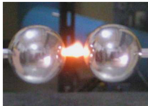
รูปที่ 7 ภาพถ่ายการเกิดเบรกดาวน์ภายในแกปทรงกลมขนาดอิเล็กโตรดทรงกลม 5 เซนติเมตร
