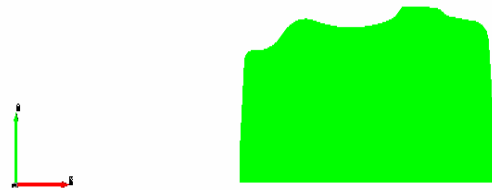
รูปที่ 1 แสดงแบบจำลองยางล้อสองมิติ (2D) และสมมาตรตามแนวแกน (axisymmetric)
