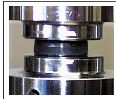
รูปที่ 3 การทดสอบการกดอัดในแนวแกนเดียว [7]
