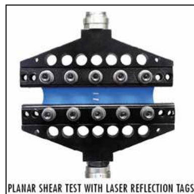
รูปที่ 4 การทดสอบการรับแรงเฉือนในแนวระนาบ [6]
