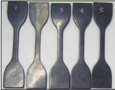
รูปที่ 2 ชิ้นทดสอบการดึงในแนวแกนเดียว
