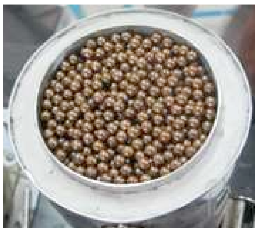
รูปที่ 2 เม็ดทองเหลืองกลมซึ่งบรรจุลงในอุปกรณ์การทดลอง เพื่อเป็นวัสดุพูนชนิดเม็ดกลมอัดแน่น
