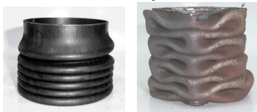
รูปที่ 1 แสดงพฤติกรรมความเสียหายของท่อทรงกระบอกกลม (ก) โมดคอนเซอร์ตินา (ข) โมดไดมอนด์
