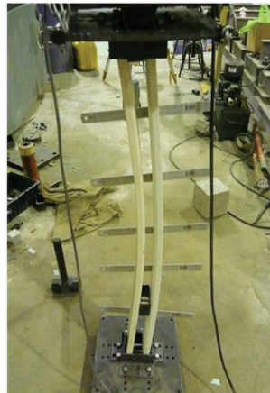
รูปที่ 7 ตัวอย่างลักษณะการวิบัติแบบ individual parallel buckling ของตัวอย่างทดสอบที่มีการติดจุดเชื่อมต่อเพิ่มที่ระยะ L/4
