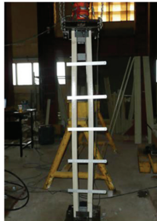
รูปที่ 8 ตัวอย่างลักษณะการวิบัติแบบ individual opposite buckling ของตัวอย่างทดสอบที่มีการติดจุดเชื่อมต่อเพิ่มที่ระยะ L/8
