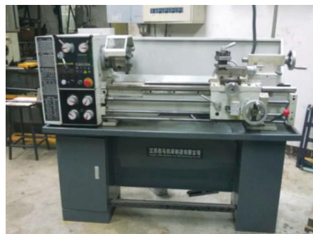
รูปที่ 1 เครื่องกลึงที่ใช้ในการหาประสิทธิภาพการทดสอบ
