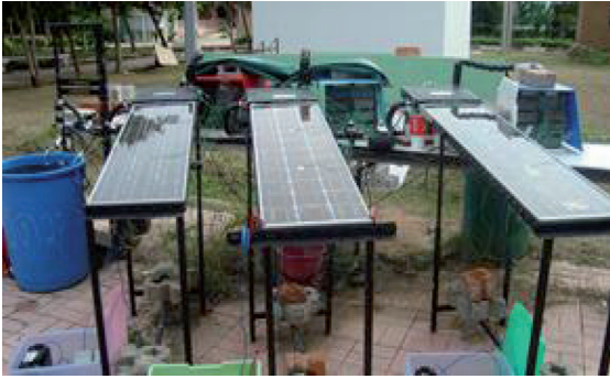
รูปที่ 8 ชุดทดสอบแผงเซลล์แสงอาทิตย์ที่ใช้ทดสอบความร้อนติดตั้งวัสดุพูนแบบตาข่ายทองแดง (HPPV)
