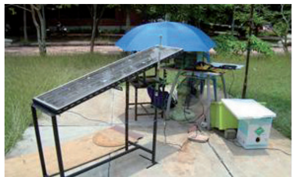
รูปที่ 7 ชุดทดสอบแผงเซลล์แสงอาทิตย์ที่ไม่ได้ติดตั้งท่อความร้อน (PV)
