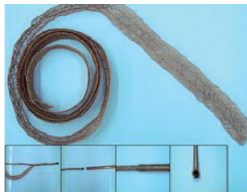
รูปที่ 2 วัสดุพูนแบบตาข่ายทองแดงที่ถักแล้ว และลักษณะของการติดตั้ง
