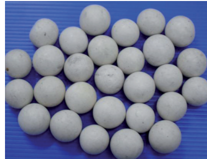
รูปที่ 2 เซรามิกส์เม็ดกลมชนิดอะลูมินา-คอร์ดีไรท์ที่เลือกใช้เป็นวัสดุพอร์นชนิดเม็ดกลมอัดแน่น
