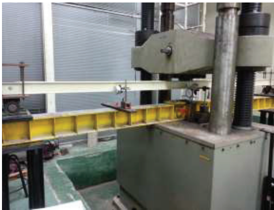
รูปที่ 6 การติดตั้งตัวอย่างทดสอบคาน CFRP
