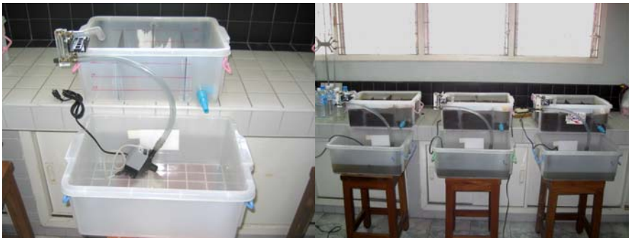
รูปที่1 แบบจำลองคลองวนเวียนขนาด 33,663 ลูกบาศก์เซนติเมตร (Oxidation Dich Model)
