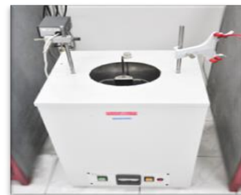
รูปที่ 2 การหาค่าความร้อนของเปลือกร่อนน้ำมันสำหรับล้างและถ่านอัดแท่ง
