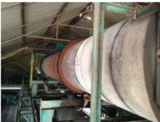
ภาพที่ 3 ท่ออบแห้งเม็ดปฏุยชนิดไหลสวนทาง (ท่อร้อน)
