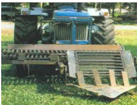
รูปที่ 4 แบบที่มีการขุดและคัดแยกดิน
