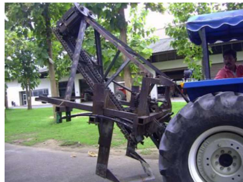
รูปที่ 5 แบบที่มีการขุดและลำเลียงเห้งงำมัน
