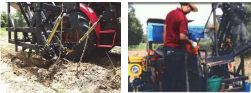
รูปที่ 7 แบบที่มีการขุด ลำเลียงเหง้า ตัดแยกเหง้าและลำเลียงผลผลิตในเครื่องเดียว
