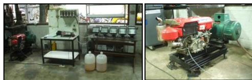
ภาพที่ 7 การติดตั้งเตรียมการทดสอบเครื่องยนต์
