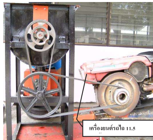
รูปที่ 5 การติดตั้งเครื่องต้นกำลังเข้ากับเครื่องจักร
