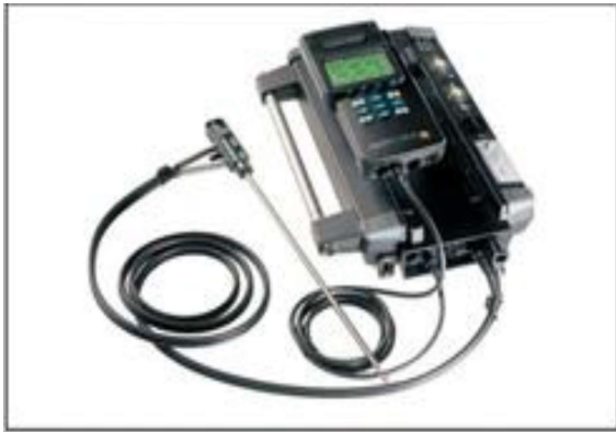
รูปที่ 4 อุปกรณ์วิเคราะห์ตัวอย่างก๊าซไอเสีย (Flue Gas Analyzer) Testo-350XL
