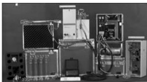
รูปที่ 3 อุปกรณ์เก็บตัวอย่างอนุภาคชนิด Flex Sampling Train System (RIGID)
