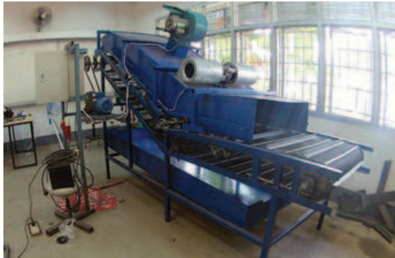
รูปที่ 3 เครื่องสลัดน้ำล้างถ่วงอกด้วยการเป่าลมแบบสายพาน
