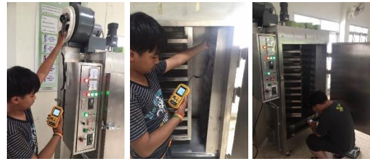
ภาพที่ 6 การวัดอุณหภูมิ ความเร็วลม ณ จุดต่างๆ ของตู้อบ
