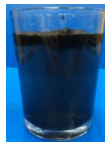
(ค) ถ่านหินที่ผ่านการปรับสภาพลอยในน้ำที่มีฟองอากาศขนาดเล็ก
