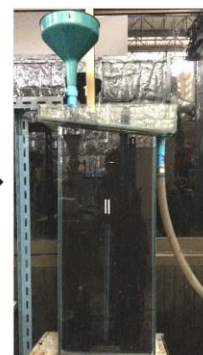
(ง) ฟองอากาศจับกับถ่านหินเริ่มไหลวนภายในคอลัมน์
