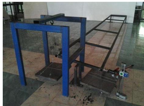
ภาพที่ 8 โครงสร้างสำหรับทดลองวัดค่ามุมบิดเพื่อหาค่าความแข็งแรงดึง
