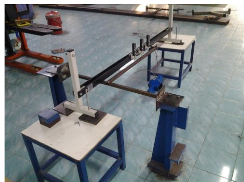
ภาพที่ 9 โครงสร้างรูปตัวที สำหรับหาค่าพารามิเตอร์ความแข็งแรงดึงของจุดเชื่อมต่อแบบยึดหยุ่น
