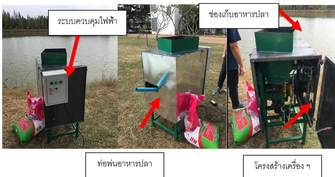
รูปที่ 2 แบบเครื่องหว่านอาหารปลาแบบตั้งเวลาอัตโนมัติ 7 ระดับ
