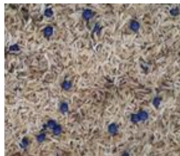
รูปที่ 7 แกลบผสมกับลูกบดความเร็วที่ 12 rpm.
