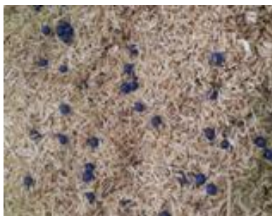
รูปที่ 6 แกลบผสมกับลูกบดความเร็วที่ 6 rpm.
