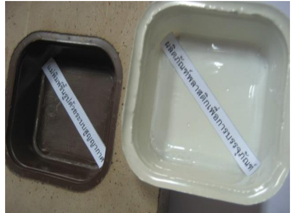
รูปที่ 4 แม่พิมพ์ขึ้นรูปด้วยสูญญากาศ และผลิตภัณฑ์พลาสติกเพื่อการบรรจุภัณฑ์
