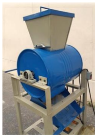
รูปที่ 3 เครื่องเมล็ดข้าวโพดออกจากซัง
