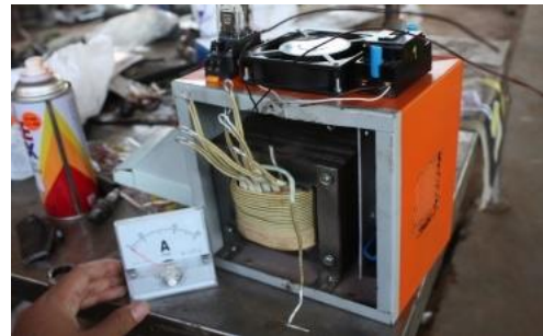
รูปที่ 7 การเลือกใช้แบตเตอรี่และการประกอบติดตั้งเครื่องประจุไฟฟ้า
