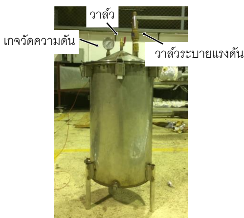
รูปที่ 2 ถังนึ่งปาล์มน้ำมันแบบนึ่งโดยตรงที่ใช้ในการทดลอง
