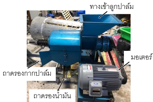
รูปที่ 6 เครื่องสกัดน้ำมันปาล์มที่ใช้ในการทดลอง
