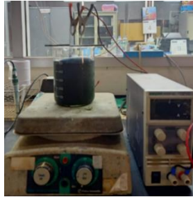
รูปที่ 1 การติดตั้งชุดการทดลองในระดับห้องปฏิบัติการ (1) DC power supply (2) Aluminum electrodes (3) EC reactor และ (4) Stirrer Plate
