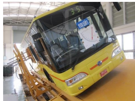
ภาพที่ 1 เครื่องทดสอบการทรงตัวบนพื้นเอียงของกรมการขนส่งทางบกสำหรับทดสอบรถโดยสาร
