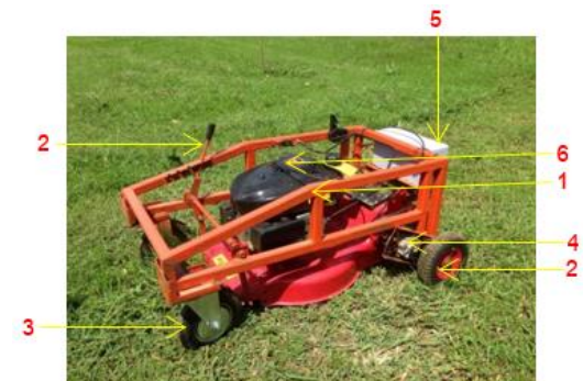
รูปที่ 10 ส่วนประกอบต่าง ๆ ของรถตัดหญ้า ควบคุมด้วยวิทยุบังคับ
