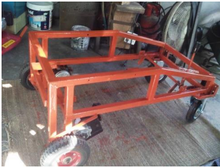
รูปที่ 1 โครงสร้างรถตัดหญ้าควบคุม ด้วยวิทยุบังคับ
