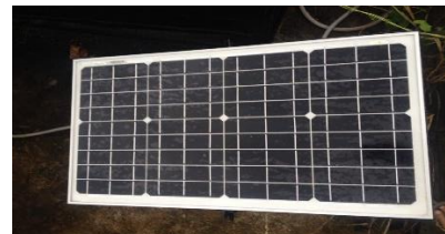
ภาพที่ 6 ติดตั้งแผงโซลาร์เซลล์ชนิดโมโนคริสตัล (Mono Crystal) 40 W 12 V
