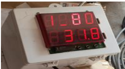
ภาพที่ 9 ติดตั้งชุดวัดอุณหภูมิและความชื้นสัมพัทธ์ภายในโรงเรือนที่ไม่ควบคุม และภายนอก
