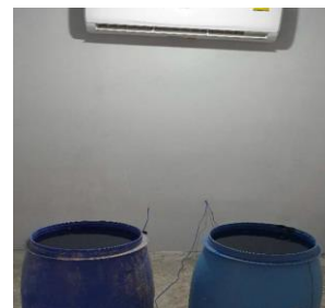
รูปที่ 2 น้ำที่ใช้เป็นโหลดในระบบทำความเย็น
