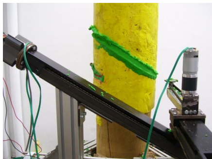
รูปที่ 11 รอยกรีดบนต้นยางพาราจำลอง เมื่อใช้ตัวควบคุมพีไอดี
