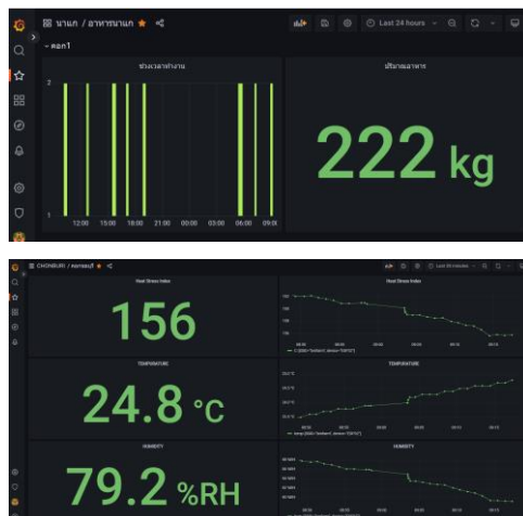
รูปที่ 7 ตัวอย่างข้อมูลอาหารที่สุกรกิน ตรวจเช็คความเครียด อุณหภูมิและความชื้น ที่ส่งขึ้นไปเก็บไว้บน Cloud
