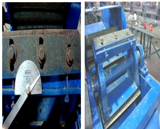
รูปที่ 3 ชุดใบมีดสับย่อยและการปรับมุมของเครื่องสับยอดกล้วยและต้นข้าวโพด
