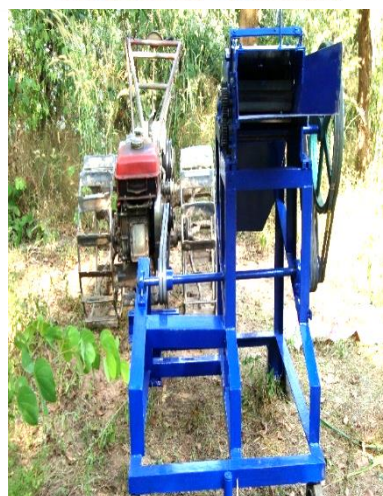
รูปที่ 6 ส่วนประกอบและติดตั้งเครื่องยนต์ต้นกำลังกับเครื่องสับขยี้และดันข้าวโพด
