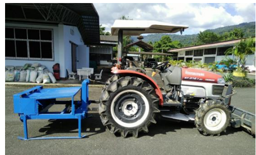
รูปที่ 2 เครื่องขับเคลื่อนสำหรับขับเคลื่อนแบบติดท้ายรถแทรกเตอร์ขนาดเล็กที่สร้าง
